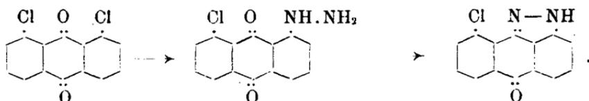
Bei höherer Temperatur und höherem Druck verwandelt sich das 5-Chlor-anthrachinonyl-1-hydrazin in das Anthrachinonylen-1.5-dihydrazin, in das unter denselben Umständen auch das 1.5-Dichlor-anthrachinon übergeht. Der Ersatz des Halogens im 8-Chlor-pyrazol-anthron durch den Hydrazinrest ist uns nicht gelungen.
